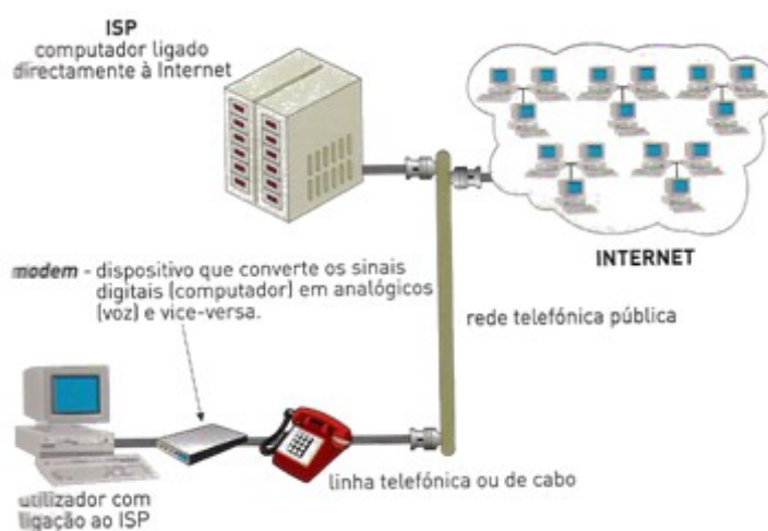
Ilustração 43: Esquema simplificado de ligação à Internet
